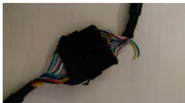
**5 - Débranchez les connexions pour vérifier l'état des broches et les repositionner si elles sont tordues**
